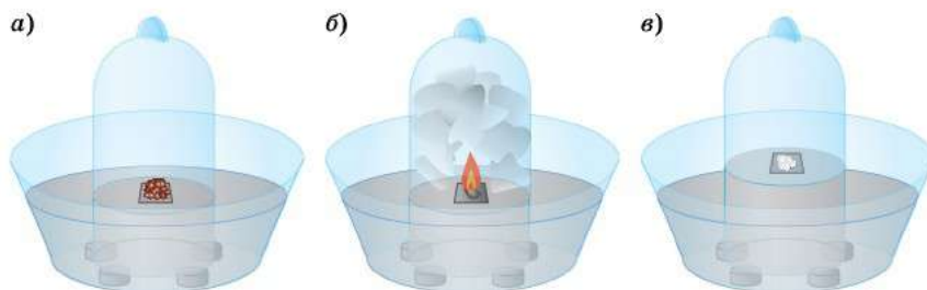
Рис. 35. Определение состава воздуха: а — перед опытом; б — фосфор горит; в — опыт закончен
