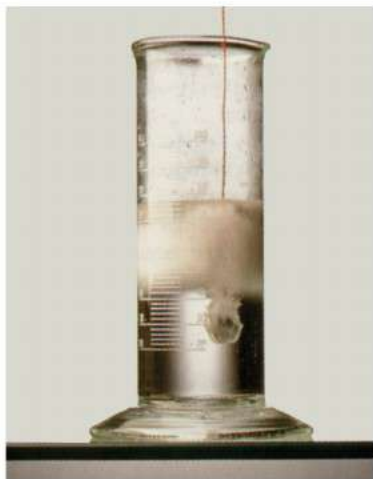
Рис. 31. Получение кислорода разложением пероксида водорода (а) и его собирание вытеснением воздуха (б) и над водой (в)
