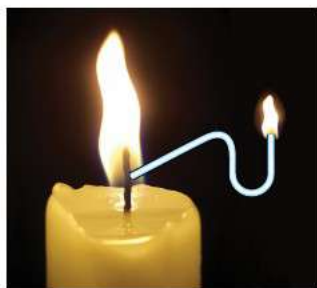
Рис. 5. Горение паров парафина, отведённых из внутренней зоны пламени свечи
