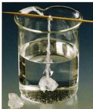
Рис. 68. Выращивание кристалла алюминиевых квасцов
