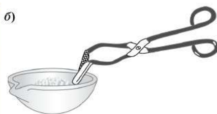
Рис. 45. Взаимодействие цинка с 30%-й и 5%-й соляной кислотой (а); хлорид цинка, выделившийся из раствора после выпаривания (б)
