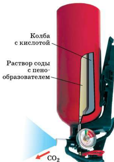
Рис. 13. Кислотный огнетушитель в действии
