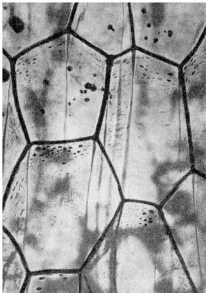
Рис. 111. Лёд под микроскопом. Видны очертания отдельных сросшихся кристаллов, имеющих форму шестигранника. Чёрные точки на фотографии — это пузырьки воздуха и воды в тех местах, где началось таяние
